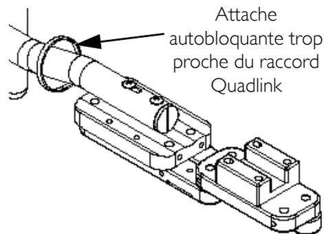
**FIGURE 2.1** Causes courantes de détérioration du câblage
