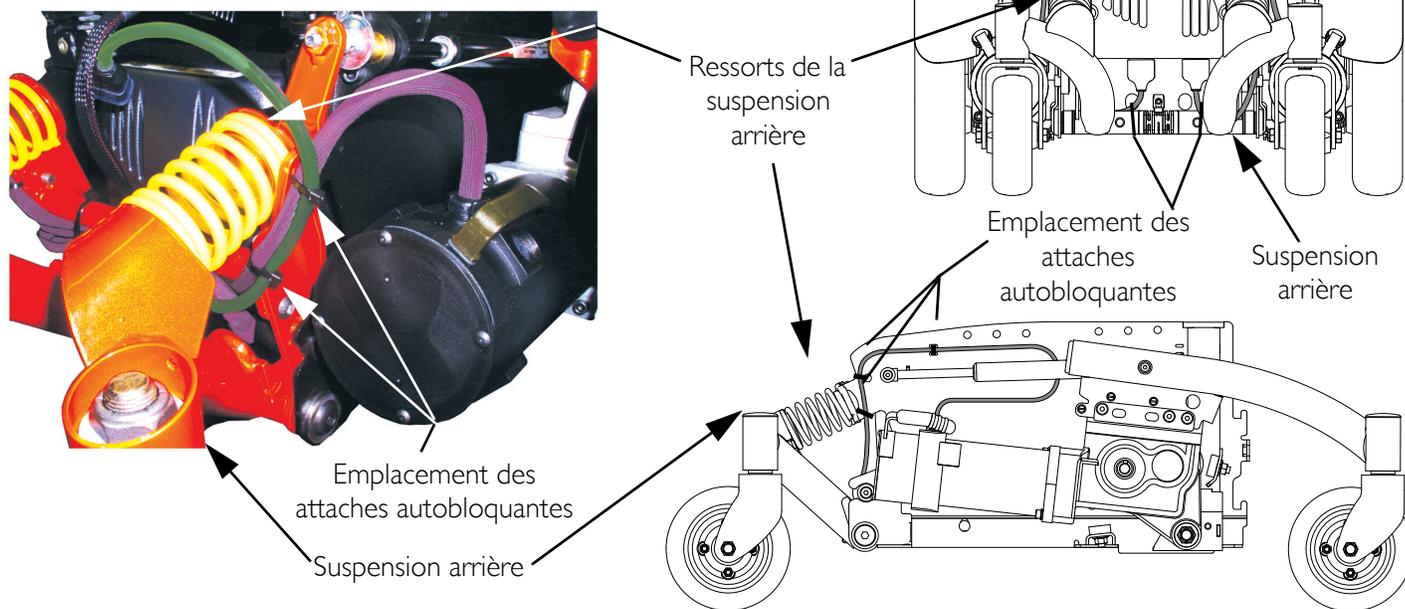
**i** Exemple des emplacements habituels des attaches autobloquantes sur le tube pivotant de la suspension arrière des fauteuils roulants TDX™ SP, SR, SI, SC et Spree.
