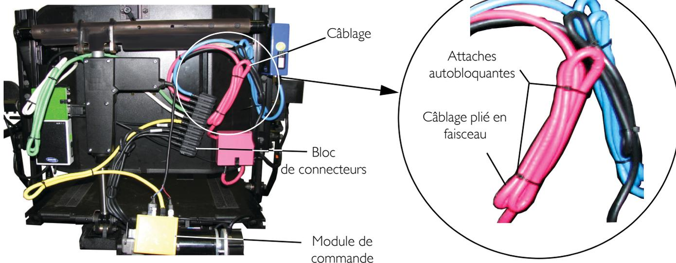
**FIGURE 2.2** Pliage des câbles en faisceau
